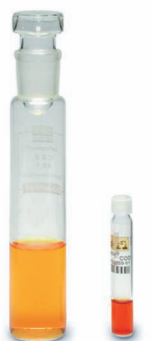
Fig. 4: Kuvettetest anvender 90% færre kemikalier end de traditionelle titreringsmetoder.
