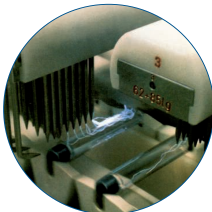
Fig. 2: 100% kontrol: Hver kuvette kontrolleres for glasfejl, før den fyldes.
