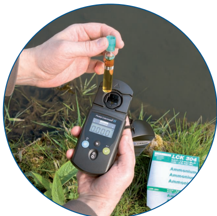
Fig. 7: Måling i felten med et tastetryk: Enkeltparameter-måleinstrumentet POCET Colorimeter II for begyndere.
